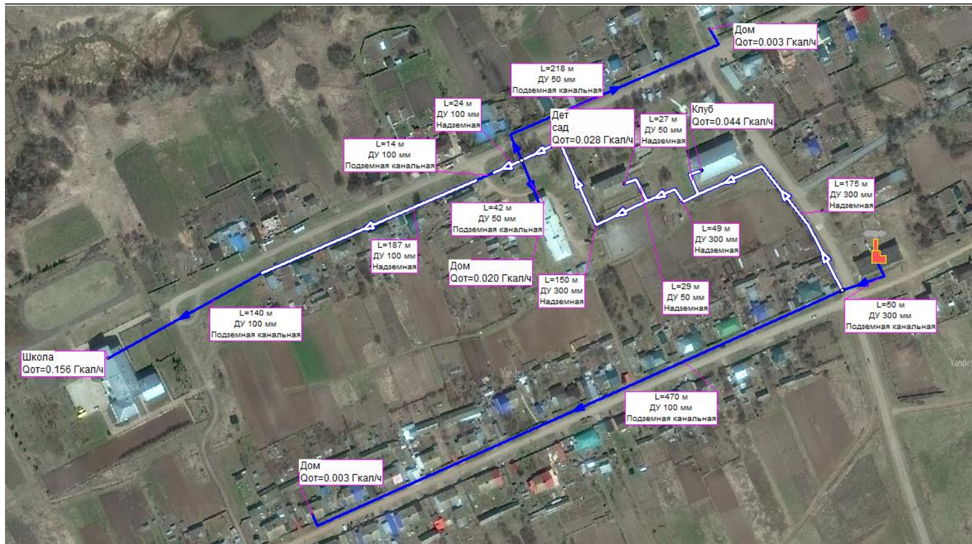
Рисунок 1.3.2 – Расчетная схема тепловой сети
